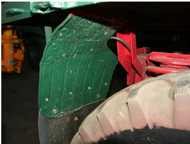
Der neu hergestellte hintere Kotflügel
