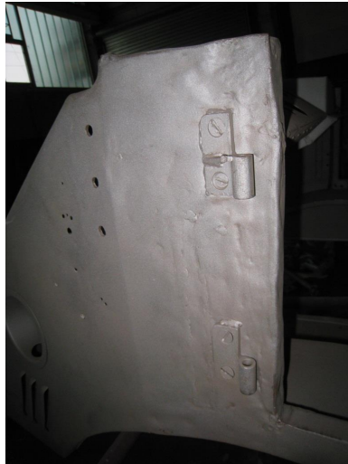
Detailaufnahme der vorderen Seitenteile, welche durch Neuanfertigungen ersetzt wurden.
