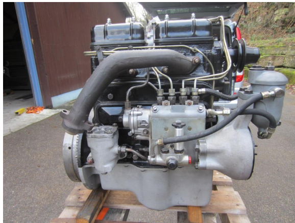
Originalmotor OM 636.912 mit geteilten Ventildeckeln und stehendem Ölfilter
