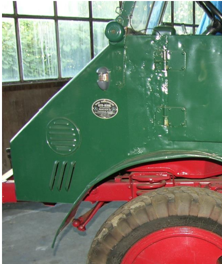
Detailaufnahme der vorderen Seitenteile, welche durch Neuanfertigungen ersetzt wurden.
